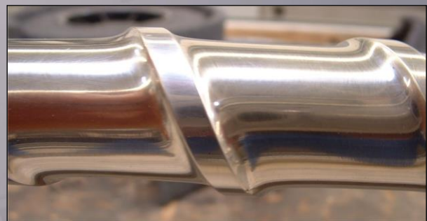
Figure 4 e 5. Rivestimento Lunac 1 in sostituzione di superleghe di nichel. A sinistra la vite nuova dopo il rivestimento; sopra dopo 4 mesi di lavoro a contatto con fluoropolimero PFA. Non è stato registrato alcun effetto di corrosione. Il materiale di base è un acciaio inox 17-4 PH con rivestimento delle creste delle viti in Stellite 12 (per le viti più grandi di Ø25mm).
