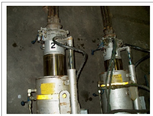
Lunac 2+ Zylinder nach 7 Jahre in (offshore) Außenluftanwendung.
