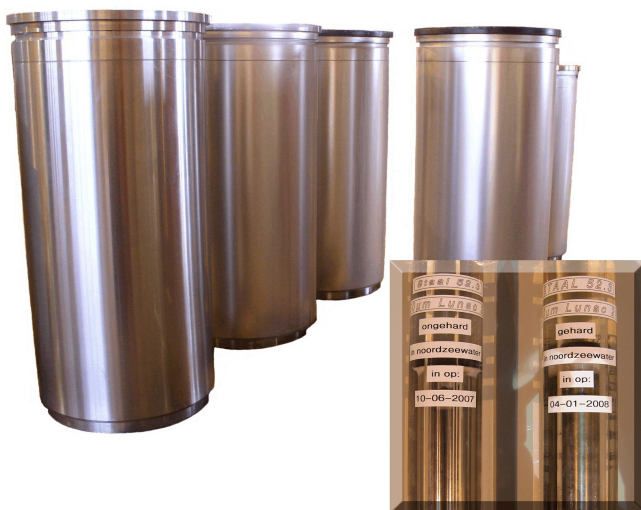
Bild 1: Lunac 2+ beschichtete hydraulische Zylindern für die Offshore-Industrie. Die Schichtdicke wird im äußeren Bereich im allgemeinen auf 45-55 µm angegeben und 10 µm auf der Innenseite. Der hohe Korrosionsschutz wird dank der völlig dichten Struktur erreicht somit der guten Abnutzungs- und Kratzfestigkeit durch die hohe Härte und Zähigkeit dieses Materials. Die Schweißqualität Verbindung wird erzeugt durch das ungestört durchgehendes Metall-Gitter. Vor allem die Zuverlässigkeit dieses Beschichtungssystems wird oft erwähnt. In den Flaschen werden St. 52.3 Stangen mit einer Lunac 2+ Schicht seit Juni 2007 in Meereswasser auf Korrosion beurteilt. Eine starke Braunverfärbung wegen Korrosion hat innerhalb 14 Tagen stattgefunden haben wenn die Schicht Mikrorissen gebildet hätte.
