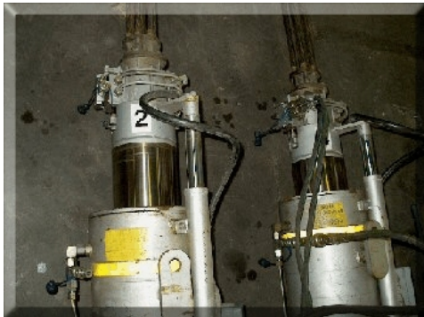
Afbeelding 2 geeft de staat weer van hydraulische cilinders, die zijn voorzien van 45 µm Lunac 2+, na 7 jaar offshore toepassingen. De krasvastheid (geen lekkende stangen) en de ondoordringbare Lunac 2+ structuur zijn hier van cruciaal belang geweest.
