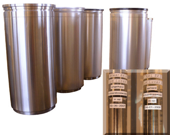
Afbeelding 1: hydraulische cilinders voor o.a. de offshore-industrie (600 ton) zijn uitwendig voorzien van 55-70 \mu\text{m} en inwendig 10 \mu\text{m} Lunac 2+. Vooral de betrouwbaarheid van dit laagstelsel wordt vaak genoemd.
